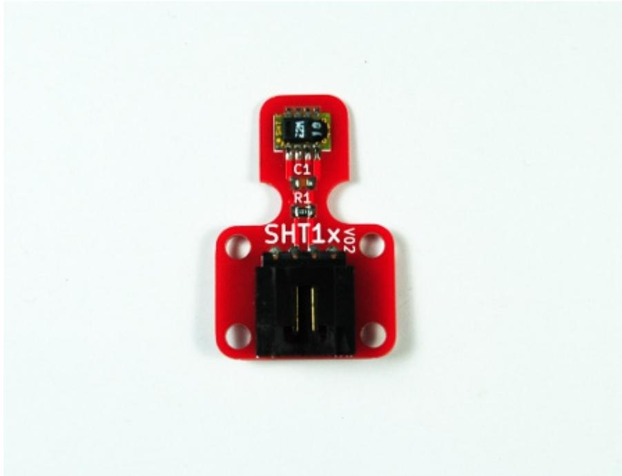
這款溫濕度感測器 SHT1x V02 就是基於 SHT 系列中使用最為廣泛的 SHT10 所設計的。與之前的 V01 版本相比，V02 版本將原有的兩路數據埠融合設計到了一個插槽中，體積更小，便於測試。原有的 V01 版本採用的是一種類似於 I2C 的兩線串列介面（bidirectional 2-wire），需要使用兩根連接線與該電子積木模組連接。而現有的 V02 版本，則只需要一條通用四線制的連接線與 Arduino 的感測器擴展板的 COM 口相連接就可以了。
