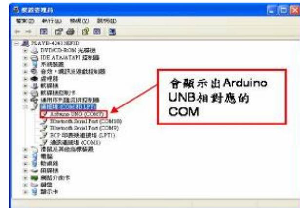
打開裝置管理員，檢查是否正確連結上Arduino UNO
